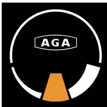
Fig.3 La couleur ambre indique que la température est réglée au niveau inférieur. (ce mode donne également lieu à des mouvements)
